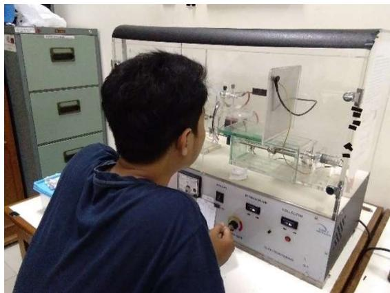
**Gambar 3.7.** Proses pembuatan membran *nanofiber* dengan mesin *electrospinning*.
