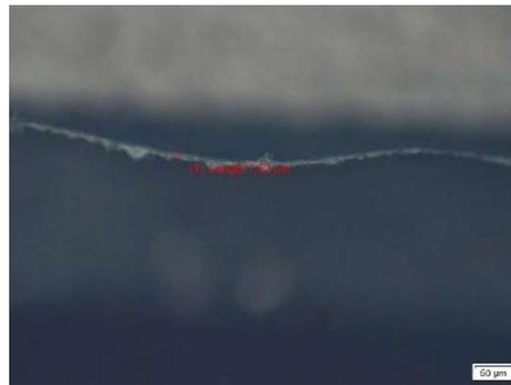
**Gambar 3.11.** Pengukuran ketebalan spesimen menggunakan *optical microscope*.
