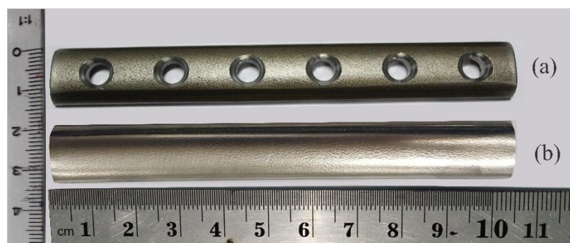
Gambar 3.15 Spesimen DCP SS AISI 316L yang diuji dalam penelitian, (a) spesimen dengan perlakuan shot peening (b) raw material
