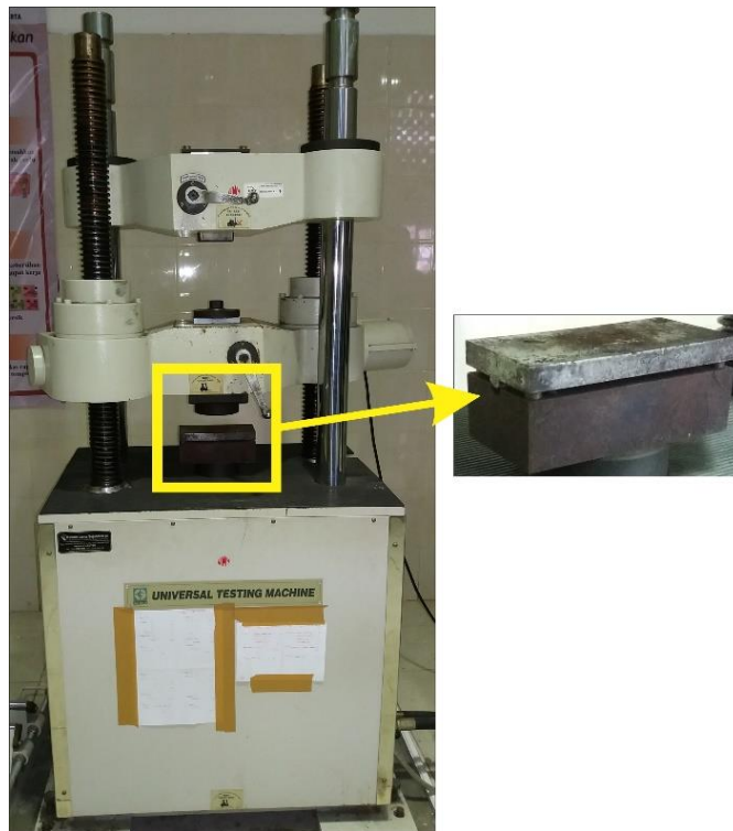
Gambar 3.2 Mesin tekan (UTM) untuk menekan DCP di dalam jig dan dies
