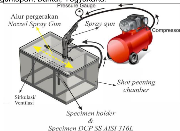
Gambar 2.2 Ilustrasi mesin dan proses shot peening
