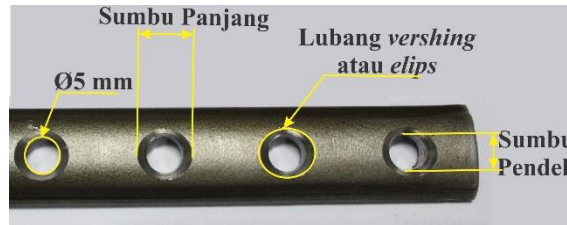
Gambar 3.14 Pengukuran sumbu panjang dan sumbu pendek lubang vershing
