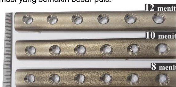
Gambar 3.3 Spesimen DCP yang dishot peening kemudian drilling
