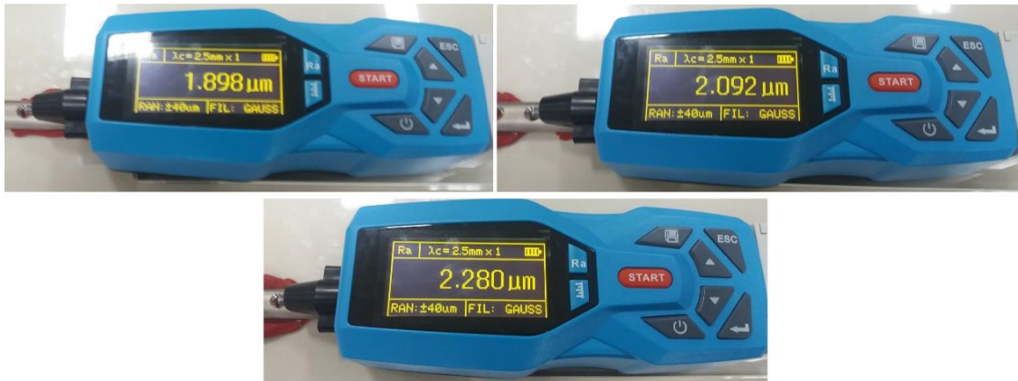
Gambar 1 Nilai kekasaran permukaan spesimen DCP SS AISI 316L yang dishot peening selama 8 menit
