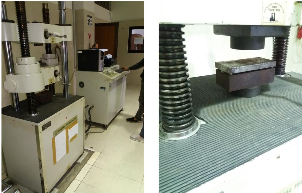
Gambar 4 Proses penekukan pelat SS AISI 316L dengan cetakan pelat DCP ( jieg dan dies ) menggunakan universal testing machine (UTM)
