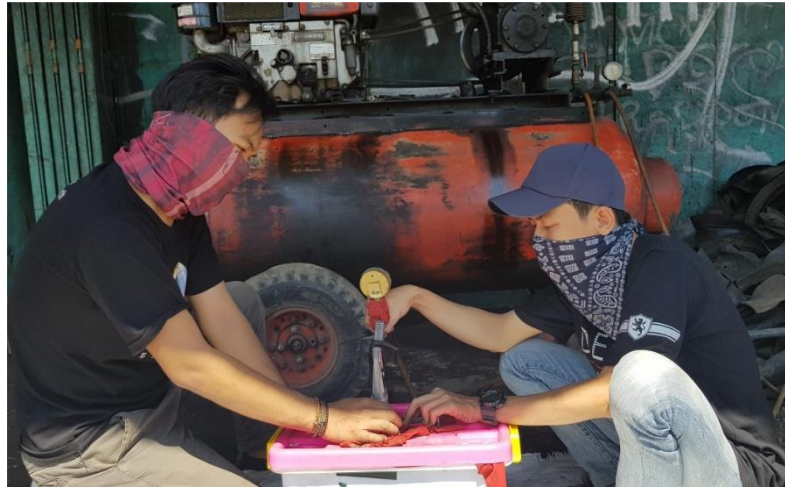
Gambar 5 Proses perlakuan shot peening pada spesimen DCP SS AISI 316L dengan variasi waktu perlakuan 8 10 dan 12 menit
