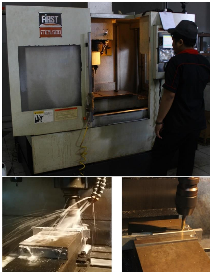
Gambar 6 Proses pembuatan lubang sekrup ( drilling ) pada spesimen DCP SS AISI 316L yang telah shot peening
