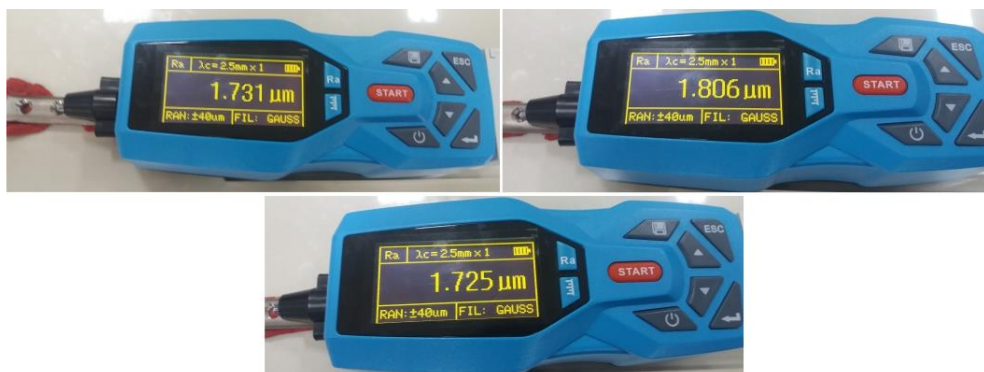
Gambar 3 Nilai kekasaran permukaan spesimen DCP SS AISI 316L yang dishot peening selama 12 menit
