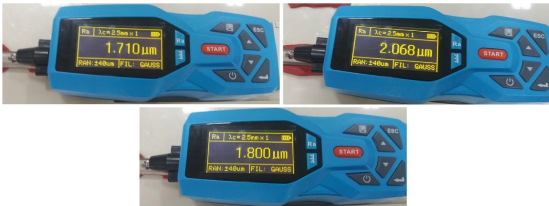
Gambar 2 Nilai kekasaran permukaan spesimen DCP SS AISI 316L yang dishot peening selama 10 menit
