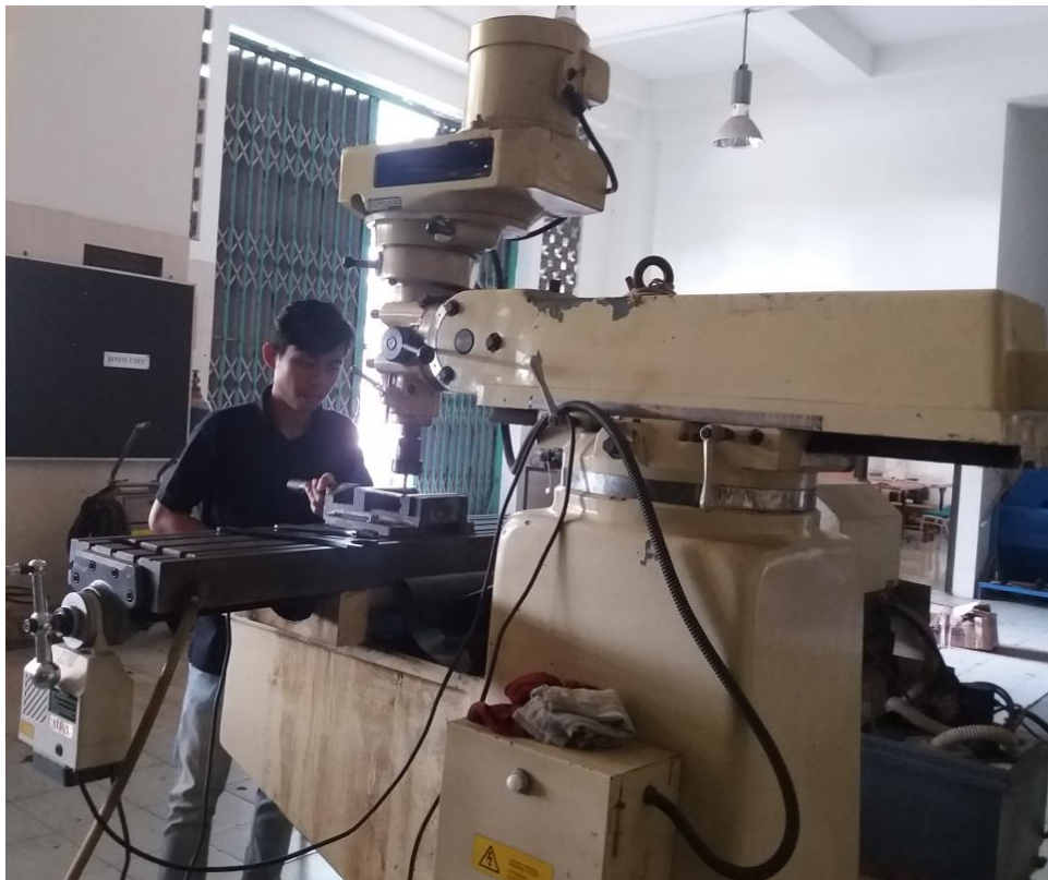
Gambar 2 Proses pengepasan dimensi pelat DCP SS AISI 316L dan proses pembuatan chamfer pada pelat SS AISI 316L menggunakan mesin frais
