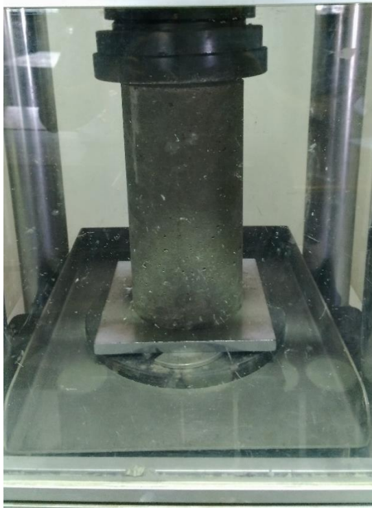
Gambar 30 Pengujian kuat tekan
