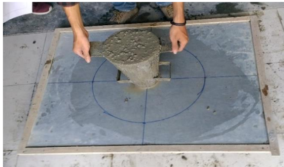
Gambar 24 Pengujian Meja Sebar (T50)
