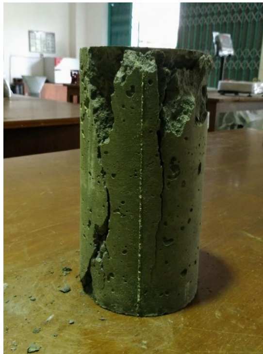
Gambar 31 Beton setelah dilakukan uji tekan
