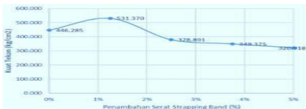
Gambar 2.13 Hubungan kuat tekan beton dengan penambahan serat polypropylene (Akkas dkk., 2013)
