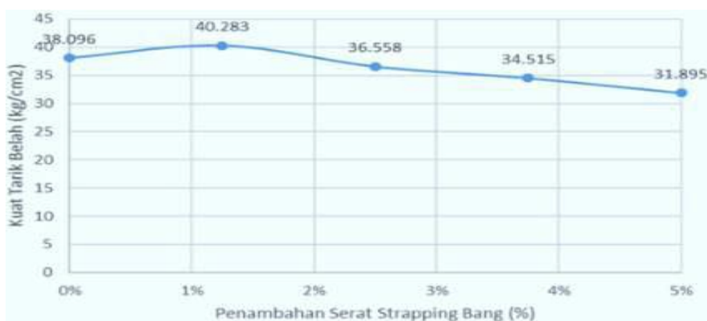
Gambar 2.14 Hubungan variasi serat polypropylene dengan kuat tarik belah beton (Akkas dkk., 2013)
