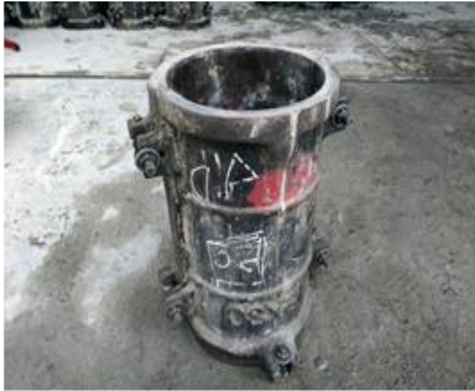
Gambar 3.6 Silinder cetakan beton
