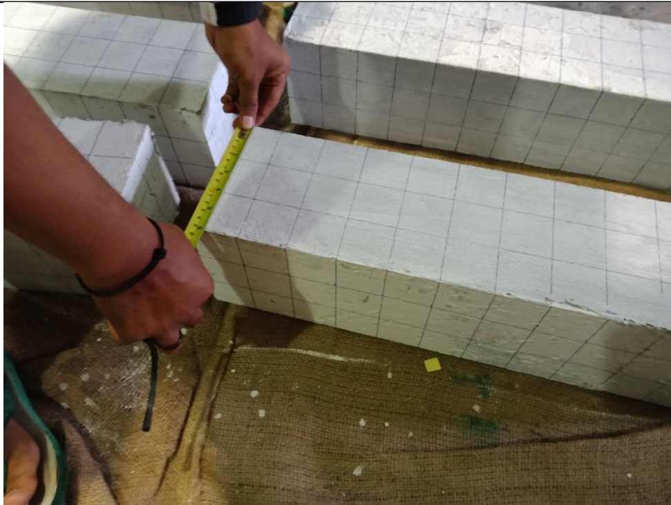
Gambar 31 pengukuran lebar benda uji balok
