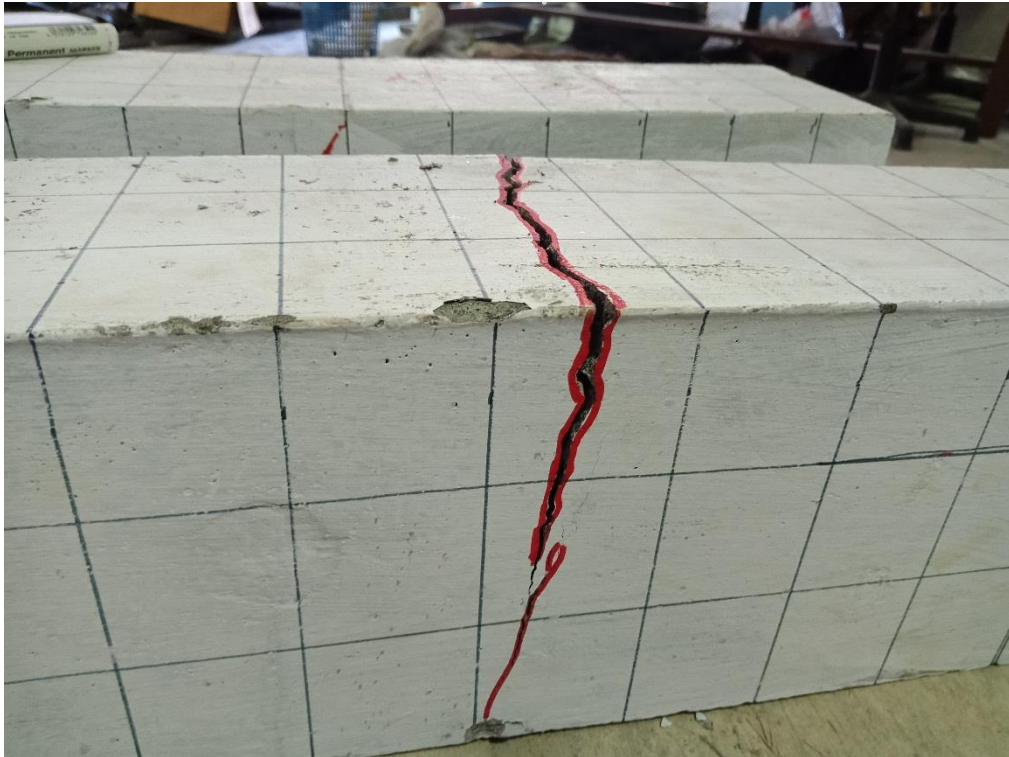
Gambar 33 beton setelah dilakukan uji tekan
