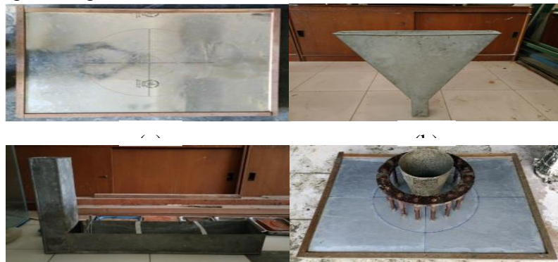
Gambar 3.15 Alat pada pengujian: (a) Meja sebar (T50), (b) V-funnel , (c) L-box , dan (d) J-ring
