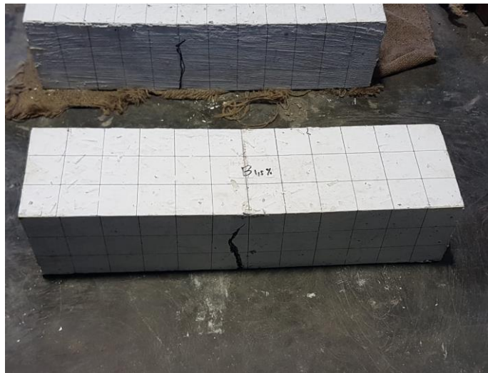
Gambar 4.20 Pola retakan dengan variasi serat polypropylene 1,5%
