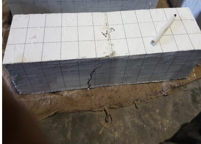
Gambar 4.19 Pola retakan dengan variasi serat polypropylene 1%
