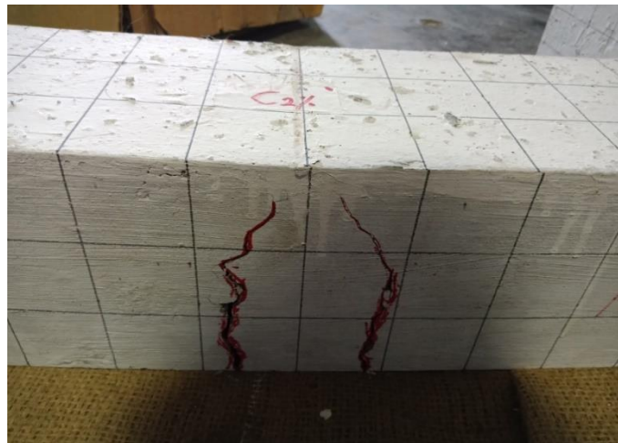
Gambar 4.21 Pola retakan dengan variasi serat polypropylene 2%
