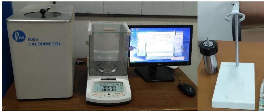
Gambar 3.20 Komponen Alat Calorimeter dari kiri : Calorimeter , Timbangan, Komputer, Calorimeter bomb , Penyangga untuk Pemasangan Benang.
