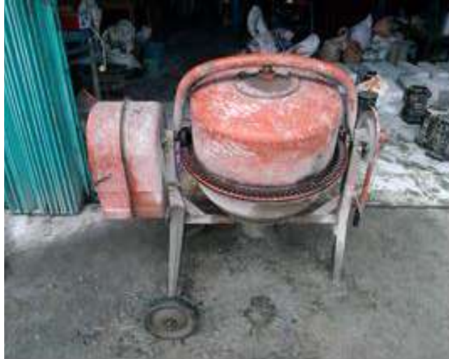
Gambar 3.5 Mixer concrete dengan kapasitas 40kg
