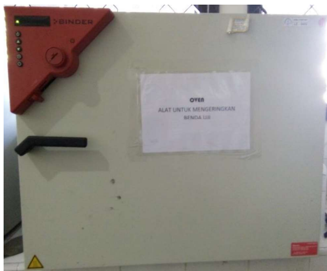
Gambar 3.11 Oven dengan suhu maksimal 220°C
