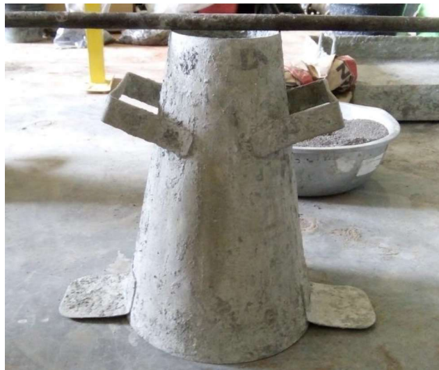
Gambar 3.6 Kerucut Abhrams untuk uji fresh properties beton segar
