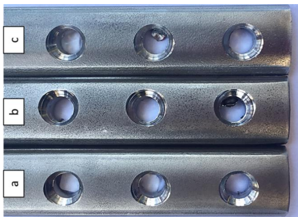
Gambar 5 DCP shot peening dan drilling variasi steel ball, (a) 0,4 mm, (b) 0,6 mm, dan (c) 0,7 mm
