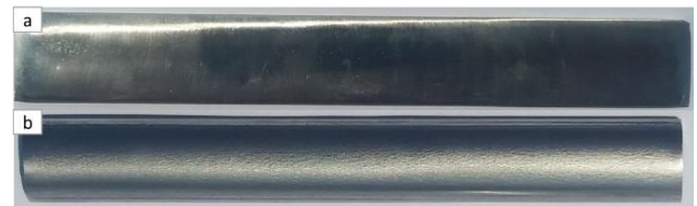
Gambar 3 Raw material, (a) sebelum bending dan (b) sesudah bending
