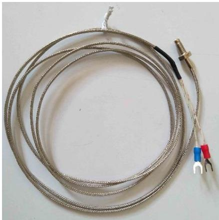
Gambar 3.7. *Thermocouple tipe K*
