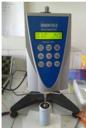
Gambar 3.12. Alat viskometer
