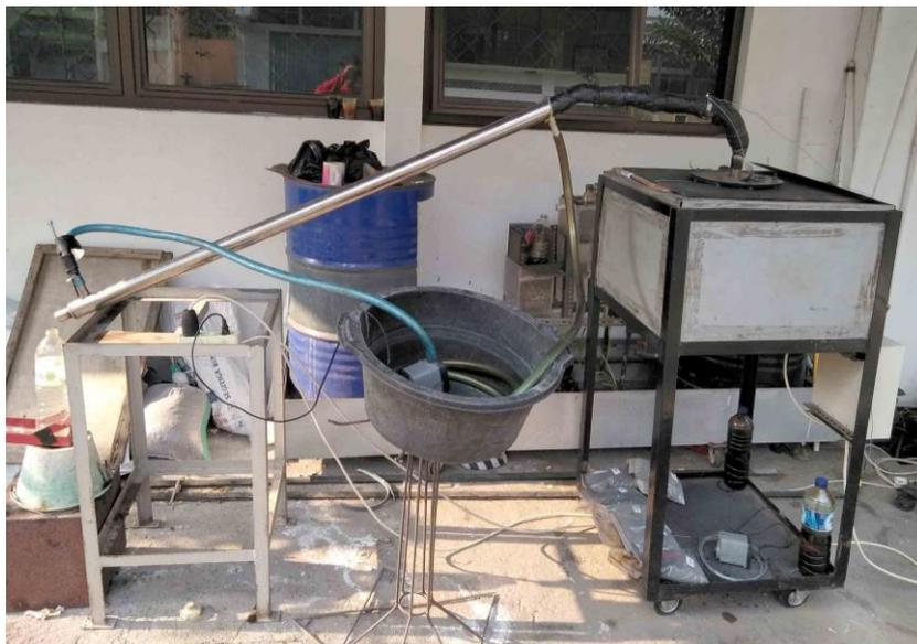
Gambar 3.4. Alat pirolisis reaktor tipe *fixed-bed*
