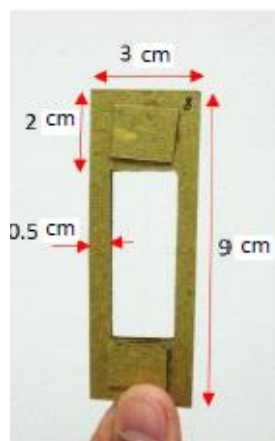
Gambar 3. 20 Spesimen uji tarik serat tunggal
