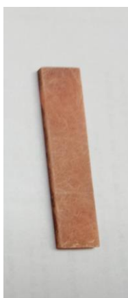
Gambar 3. 23. Spesimen siap uji sesuai ASTM D-790
