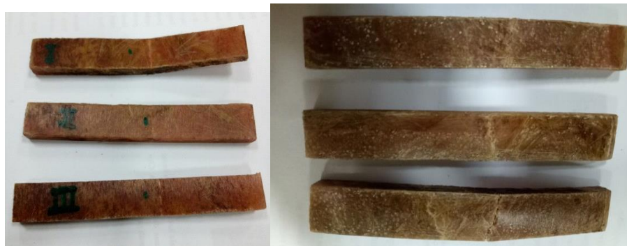
Gambar 4. 4 Spesimen Uji Bending dengan 3 Variasi Pencucian
