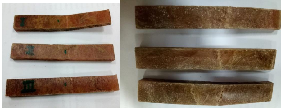
Gambar 2.2 Spesimen Uji Bending dengan 3 Variasi Pencucian
