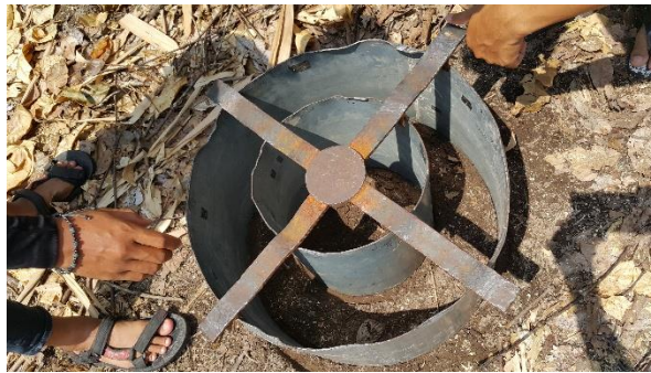
Gambar 3.24 Pemasangan double ring infiltrometer
