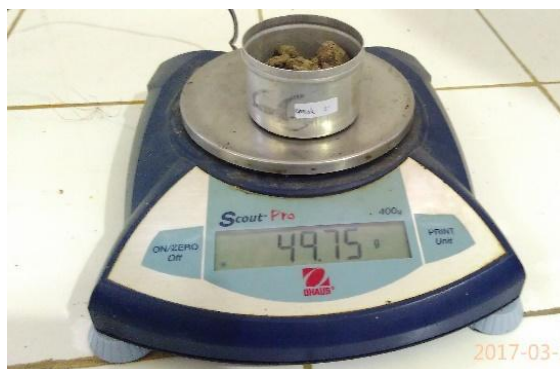
Gambar 3.30 Penimbangan cawan + tanah kering
