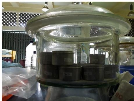
Gambar 3.29 Sampel tanah dalam desikator
