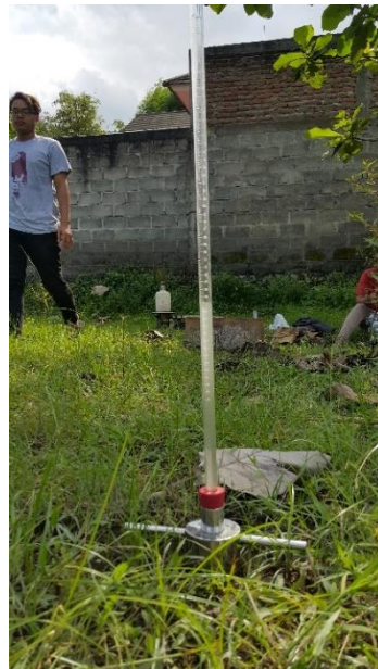
Gambar 3.23 Pengambilan sampel tanah
