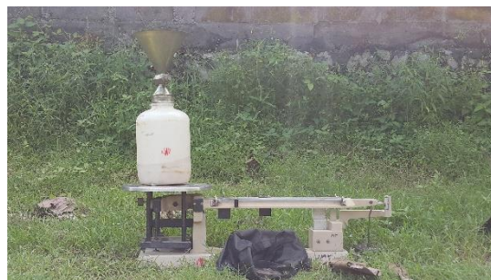
Gambar 3.22 Penimbangan sisa pasir
