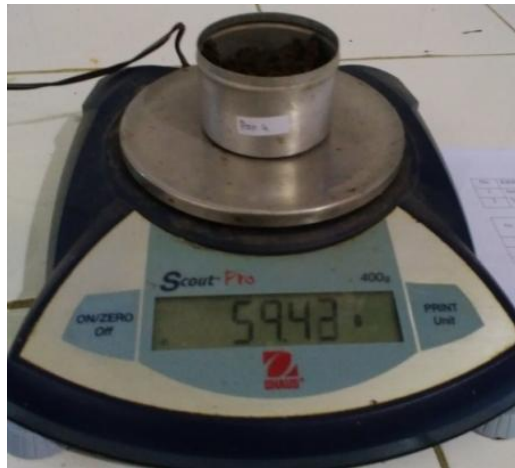
Gambar 3.28 Penimbangan cawan + tanah basah
