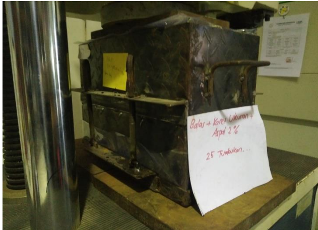
Gambar 3.17 Ballast box berada pada mesin kuat tekan
