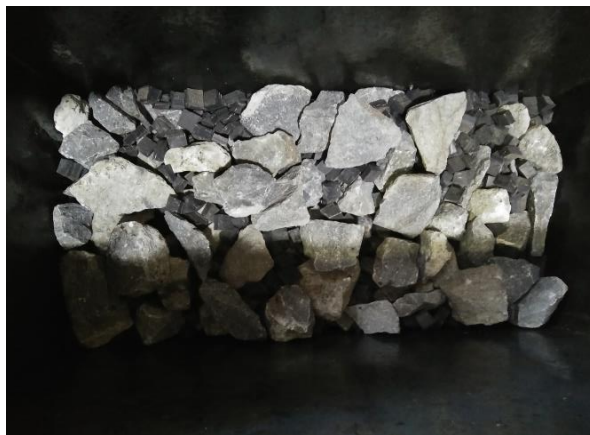
Gambar 3.12 Pencampuran benda uji di dalam ballast box
