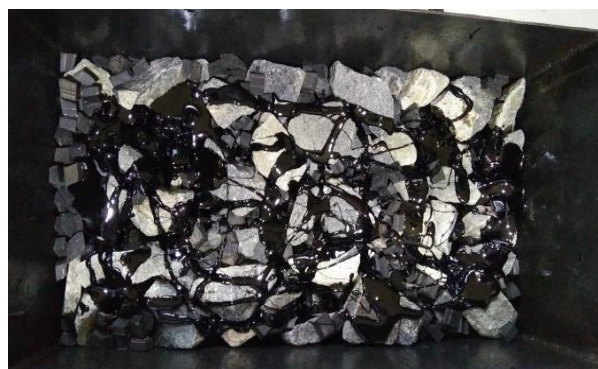
Gambar 3.10 Penuangan aspal pada benda uji
