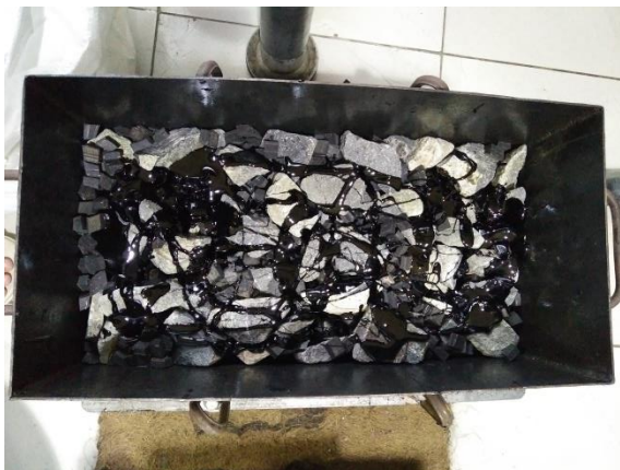
Gambar 3.14 Penuangan aspal diatas campuran balas dan karet
