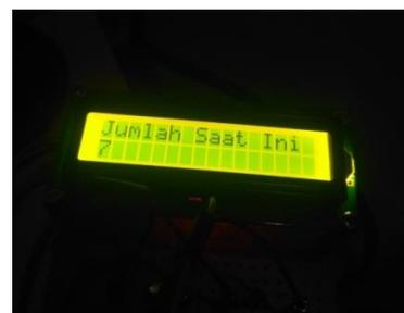
Gambar 4.33 Hasil Pengujian LCD Yang Telah Menampilkan Jumlah Orang
