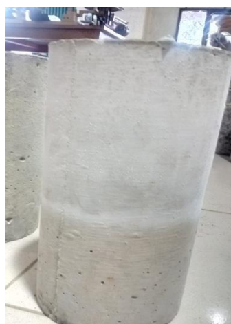
Gambar 4.2 Benda uji sebelum di uji tekan
