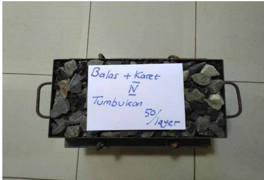
Gambar 3.9 Benda uji setelah dipadatkan
