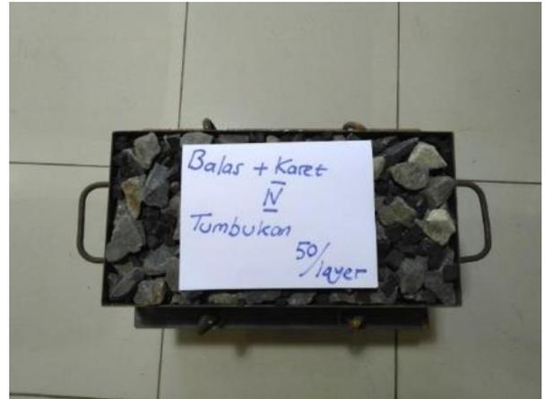
Gambar 3 Benda uji yang sudah dipadatkan
