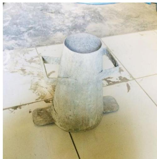
Gambar 8. Kerucut *abrams*
