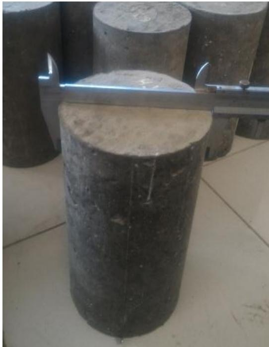
Gambar 21. pengukuran dimensi beton
