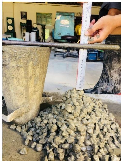
Gambar 20. Pengujian *slump*
