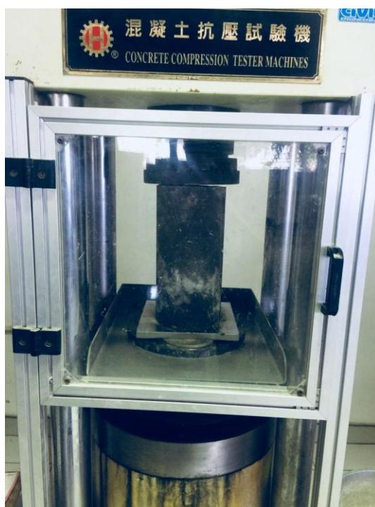
Gambar 22. Pengujian kuat tekan beton
