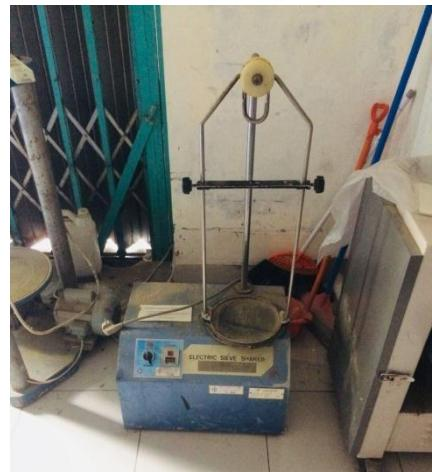
Gambar 4. Mesin pengayak agregat
