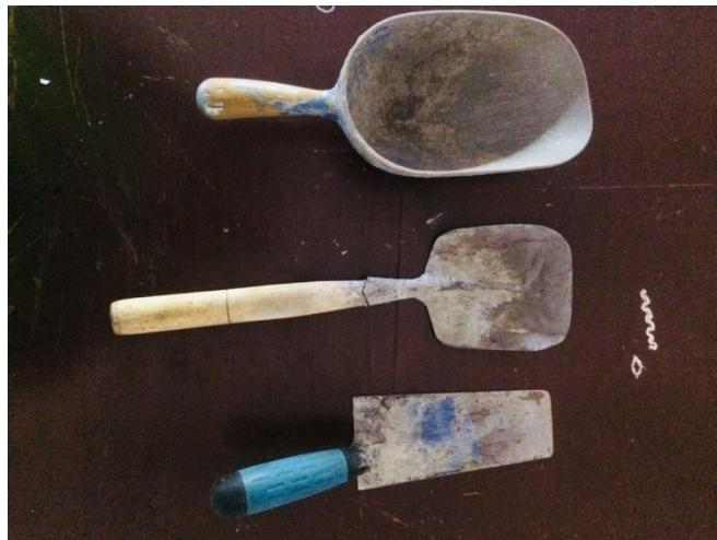
Gambar 7. Sendok adukan beton (cetok)
