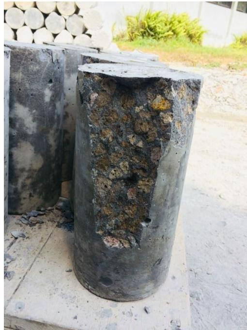
Gambar 23. Beton setelah diuji kuat tekan
