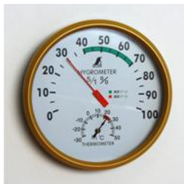
Gambar 7. Alat ukur kelembaban
