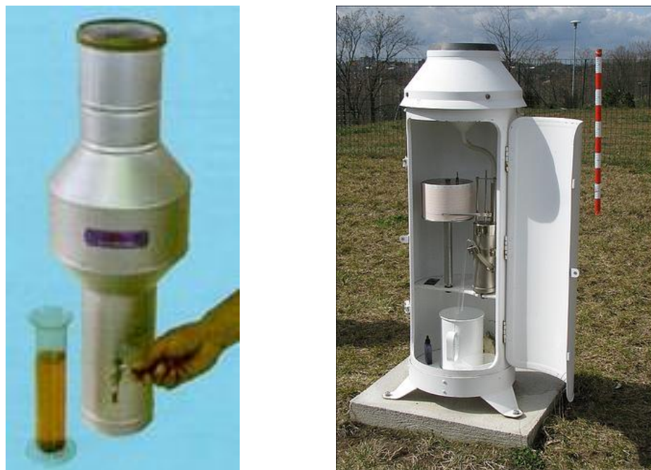
Gambar 8. Ombrometer dan ombrograf
