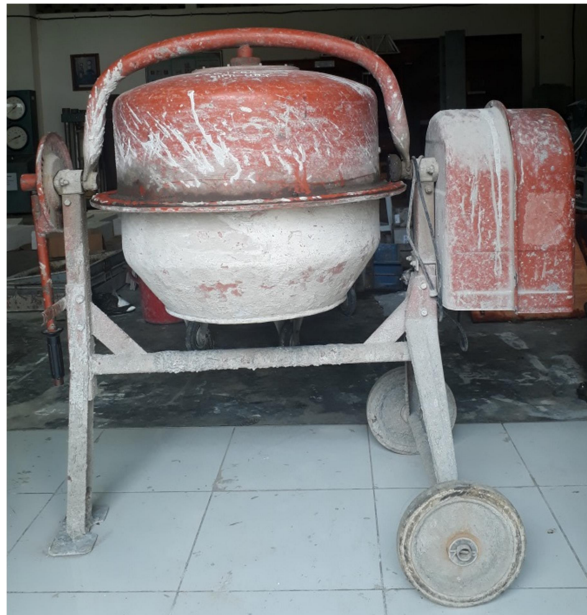
Gambar 3. 5 Mixer dengan kapasitas 40 kg
