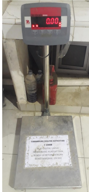
Gambar 3. 2 Timbangan digital dengan ketelitian 5 gram
