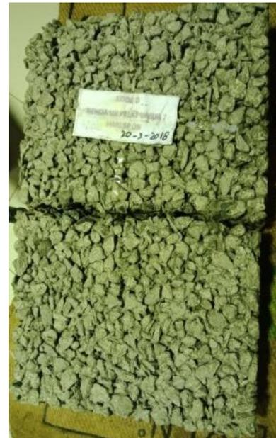
Gambar 12 Benda uji pelat beton non pasir setelah uji lentur
