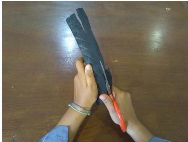
Gambar 3. 2 Pemotongan karet ban bekas
