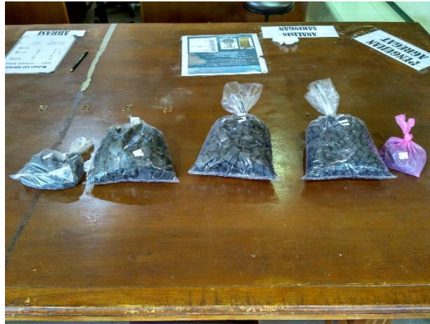
Gambar 3. 4 Persiapan karet ban bekas yang sudah dipotong dan ditimbang
