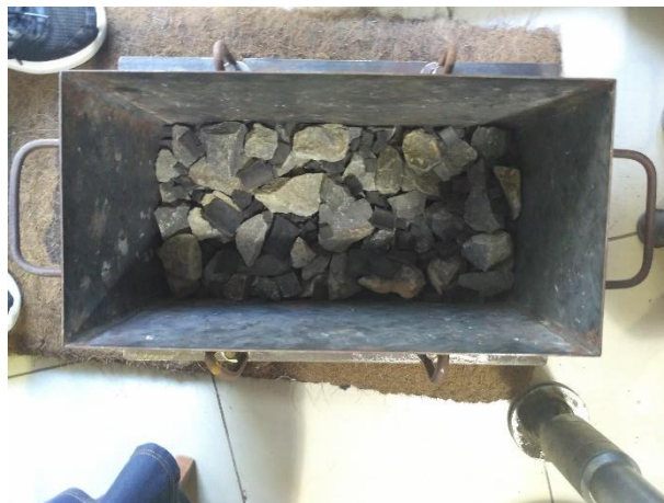
Gambar 3. 5 Agregat dan karet sudah berada dalam cetakan
