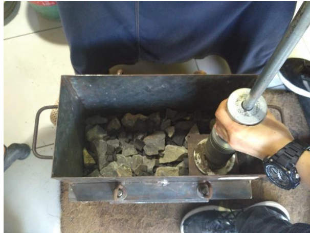
Gambar 3. 6 Penumbukan pada lapisan pertama
