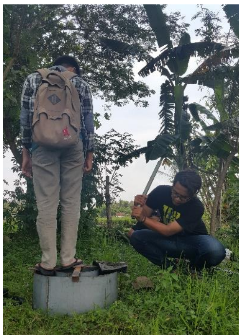
Gambar 3.7 Proses penanaman cincin ke dalam tanah
