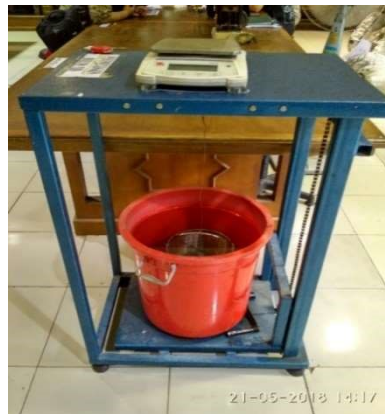
Gambar 3.38 Timbangan dalam air
