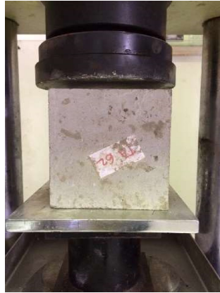
Gambar 3.44 Pengujian kuat tekan tahap 1
