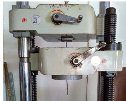
Gambar 3.43 Pengujian Kuat tarik baja
