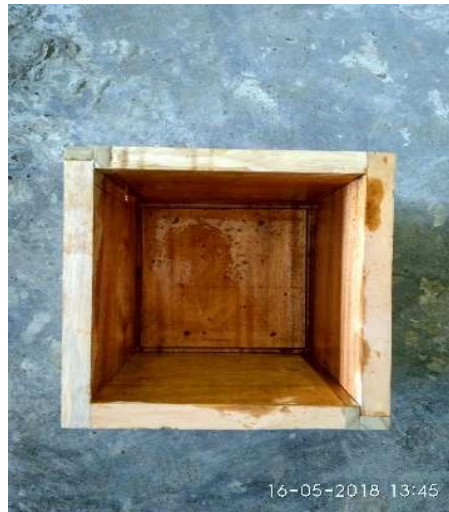
Gambar 3.34 Cetakan perbaikan beton kubus
