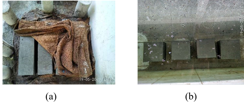
Gambar 3.42 (a) perawatan kubus beton (b) perawatan balok beton
