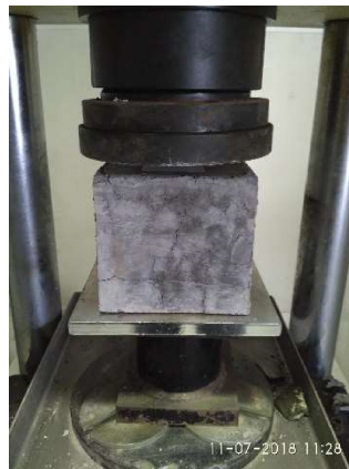
Gambar 3.47 Pengujian kuat tekan tahap 2
