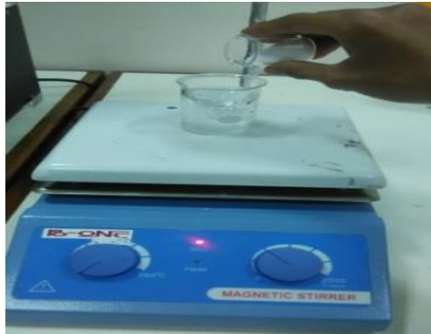
Gambar 3.20. Proses pembuatan larutan spinning ( w / w )
