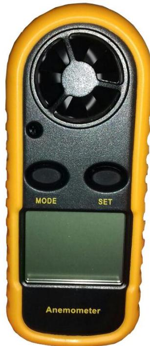
Gambar 3.11 Anemometer
