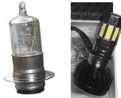
**Gambar 1.** Lampu utama LED 6 sisi dan lampu utama standar
