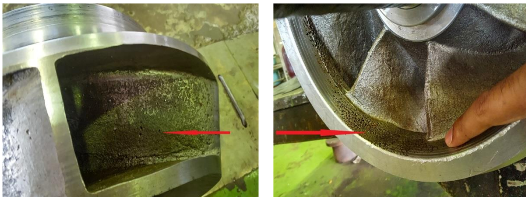
Gambar 2.3 Kavitasi pada impeller pompa
