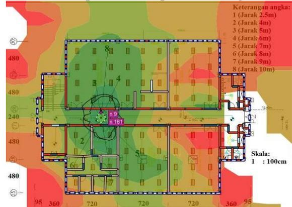
Gambar 8 Hasil pemodelan SNR Gedung F4 Lantai Dasar – AP1
