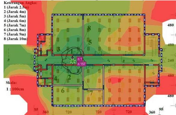
Gambar 4 Hasil pemodelan SNR Gedung F1 Lantai Dasar – AP1
