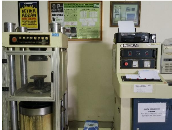
Gambar 3.1. Mesin uji tekan Merk Hungta
