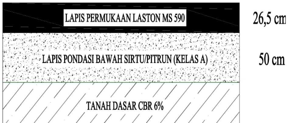
Gambar 4.4 Tebal perkerasan metode AUSTROADS
