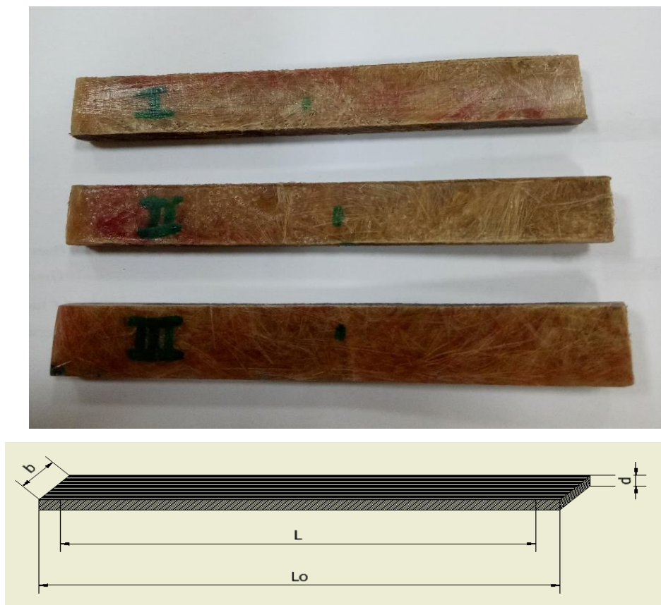
Gambar 3.17 Bentuk dan ukuran spesimen sesuai standar (ASTM D790)
