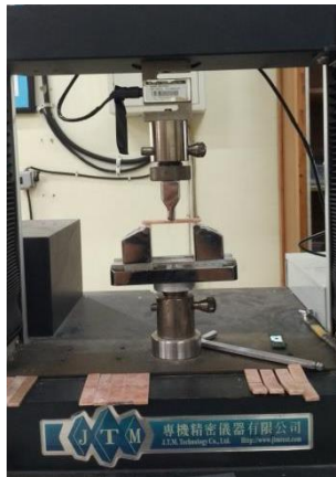
Gambar 3.18 Posisi pemasangan spesimen L=74
