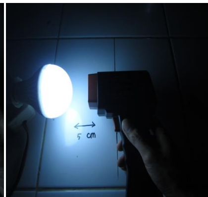
(d) Pengukuran suhu lampu LED BULB
