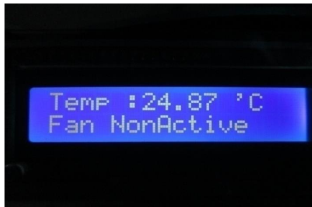
Gambar 4.6 Tampilan pembacaan suhu pada LCD 16x2
