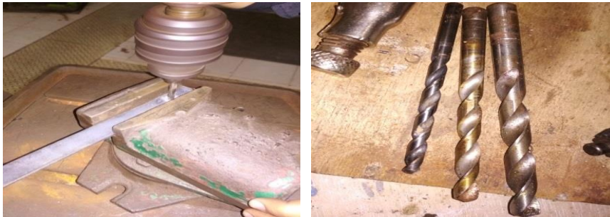
Gambar 4.12 Proses pengeboran dan pahat yang digunakan
