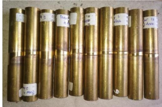
Gambar 2.5. Spesimen uji tarik (Standar *JIZ Z 2201*).
