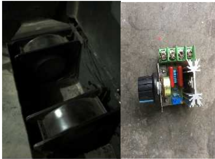
Gambar 3.13 Pemasangan Fan dan Dimmer
