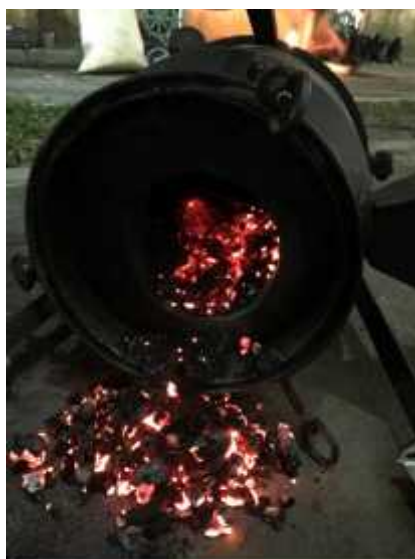
Gambar 3.19 Pengeluaran sisa biomassa yang sudah dibakar
