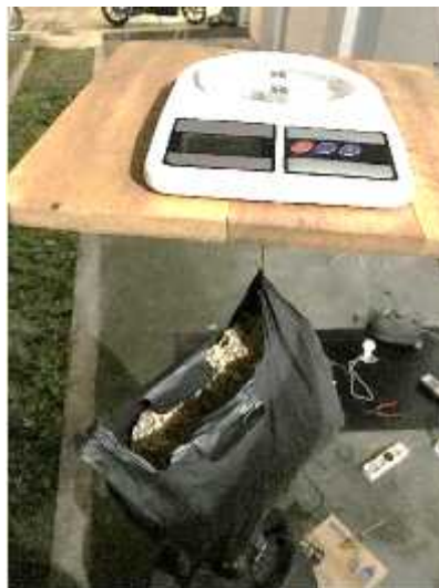
Gambar 3.14 Proses penimbangan biomassa dan arang
