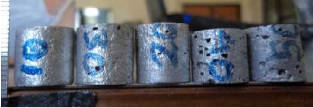
Gambar 6. Spesimen setelah proses sintering langsung diambil dari furnace dilihat dari samping
