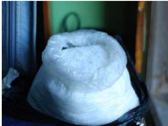
Gambar 1 Serbuk urea yang digunakan sebagai space holder
