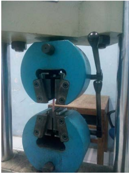
Gambar 1. Pengujian uji tarik dengan UTM
