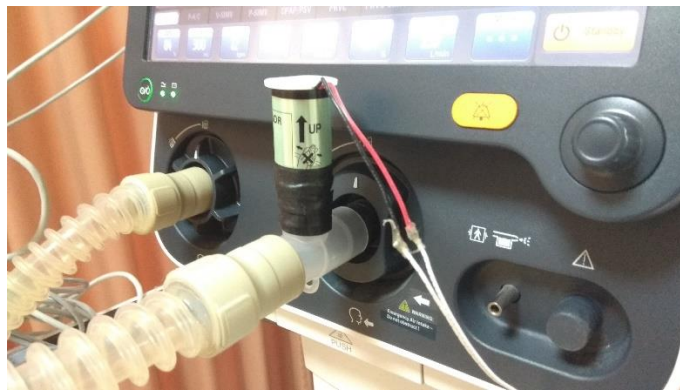
Pemasangan sensor oksigen pada alat pembeding
