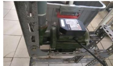
Gambar 4. Pompa air
