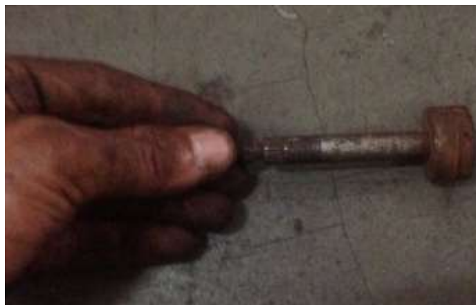
Gambar 3.8 Pengecekan Push Rod
