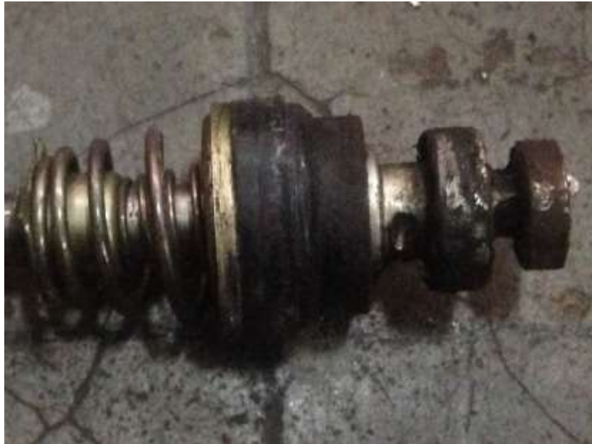
Gambar 3.9 Pemansangan Control Valave Mechanism
