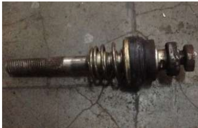
Gambar 3.7 Pengecekan Operati Rod
