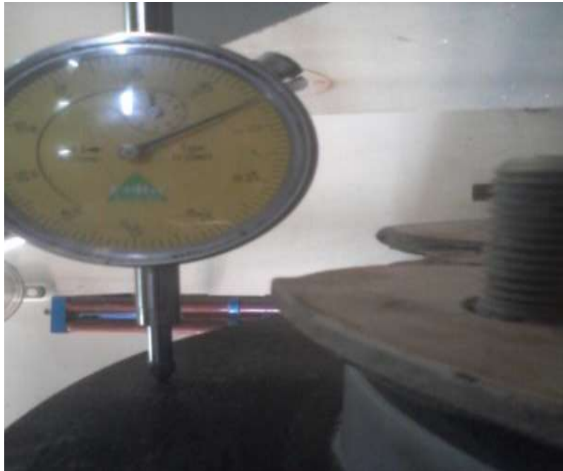
3.23 Gambar Pengukuran Kerataan Disc Brake
