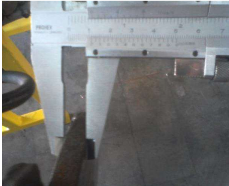
3.22 Gambar Pengukuran Ketebalan Disc Brake
