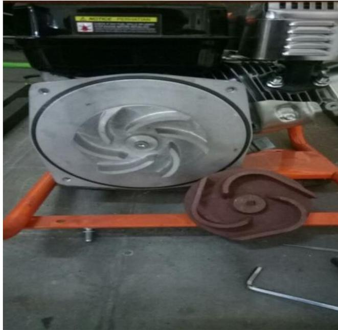
Gambar 4.5 Hasil Pembuatan *Impeller*
