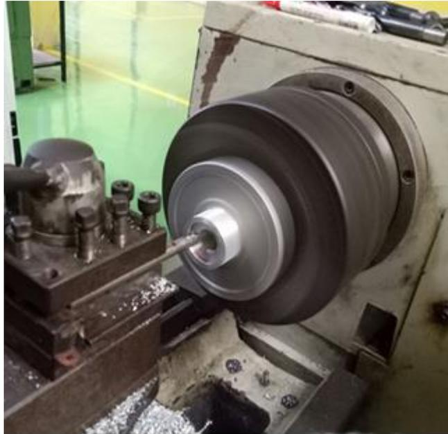
Gambar 4.4 Proses *Finishing* Pada *Impeller*
