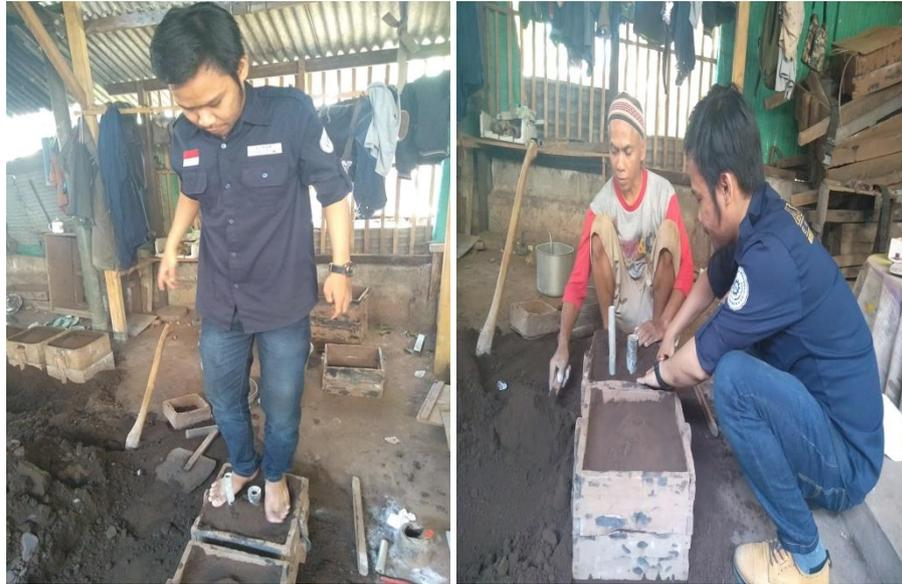
Gambar 4.1 Proses Pembuatan Cetakan *Impeller*
