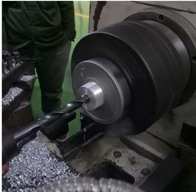
Gambar 4.2 Proses *Boring* Pada *Impeller*
