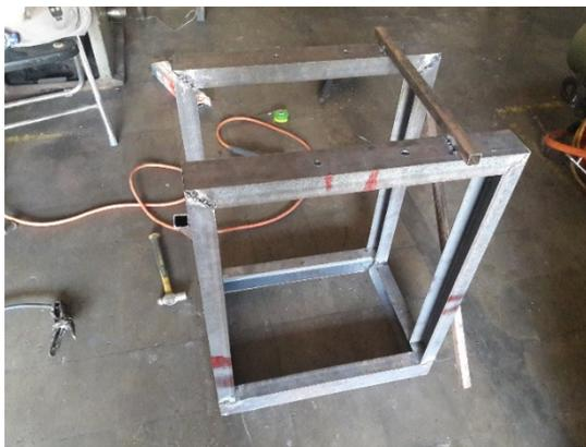
Gambar 3.6 perakitan kerangka mesin
