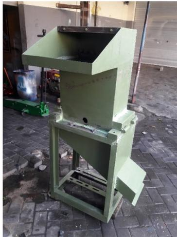
Gambar 3.7 mesin pencacah botol plastik
