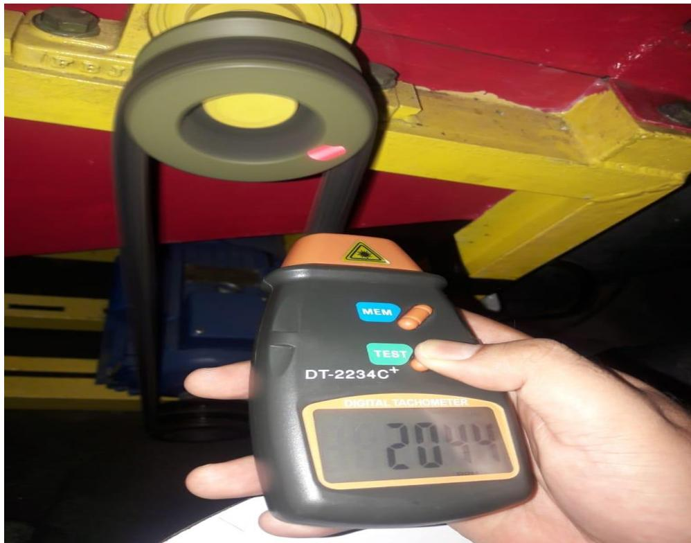
Gambar 4.11 Hasil pengukuran rpm dengan menggunakan alat *Digital Photo Tachometer*.
